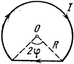
**Задание 2.** Определить индукцию магнитного поля в точке  $O$ , если проводник с током  $I$  имеет вид, показанный на рис. Радиус изогнутой части проводника равен  $R$ , прямолинейные участки проводника предполагаются очень длинными.
